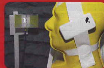
Präzise: Am künstlichen Kopf wird die effektive Strahlungsleistung gemessen, die Basis für den Strahlungsfaktor.
