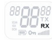
Das Gerät ist immer im Empfangs-Modus, wenn es eingeschaltet ist und nicht sendet. Wenn Sie im eingestellten Kanal und CTCSS ein Signal empfangen, erscheint das RX-Symbol im Display.
