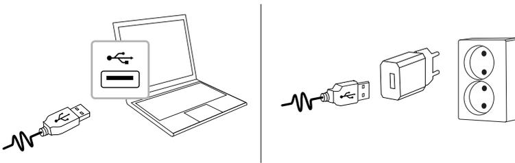
Stecken Sie das schmale Ende
