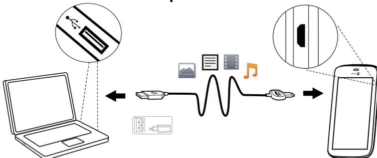
Schließen Sie das Telefon an einen Computer an und beginnen Sie mit der Übertragung von Bildern, Musik und anderen Dateitypen. Hierzu müssen Sie ein USB-Kabel zwischen dem Telefon und dem Computer
